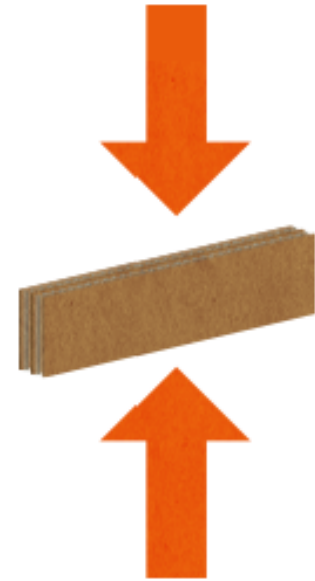
ECT (Edge Crush Test) eli reunalitistyslujuus
